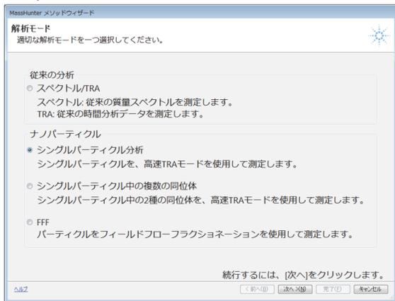
Fig. 1 メソッドウィザードのナノ粒子モード選択画面
